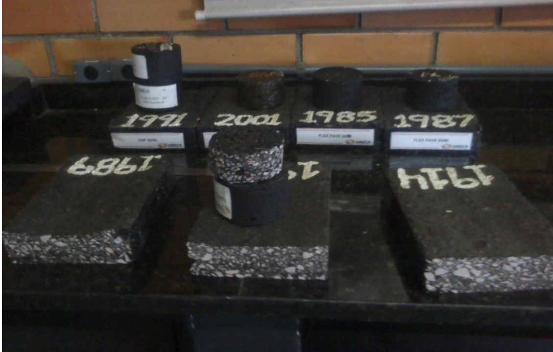
Figura 2.10 – Mostras de asfaltos: o 1º à esquerda está “afundado”, é o tipo comum (GRECA ASFALTOS)
