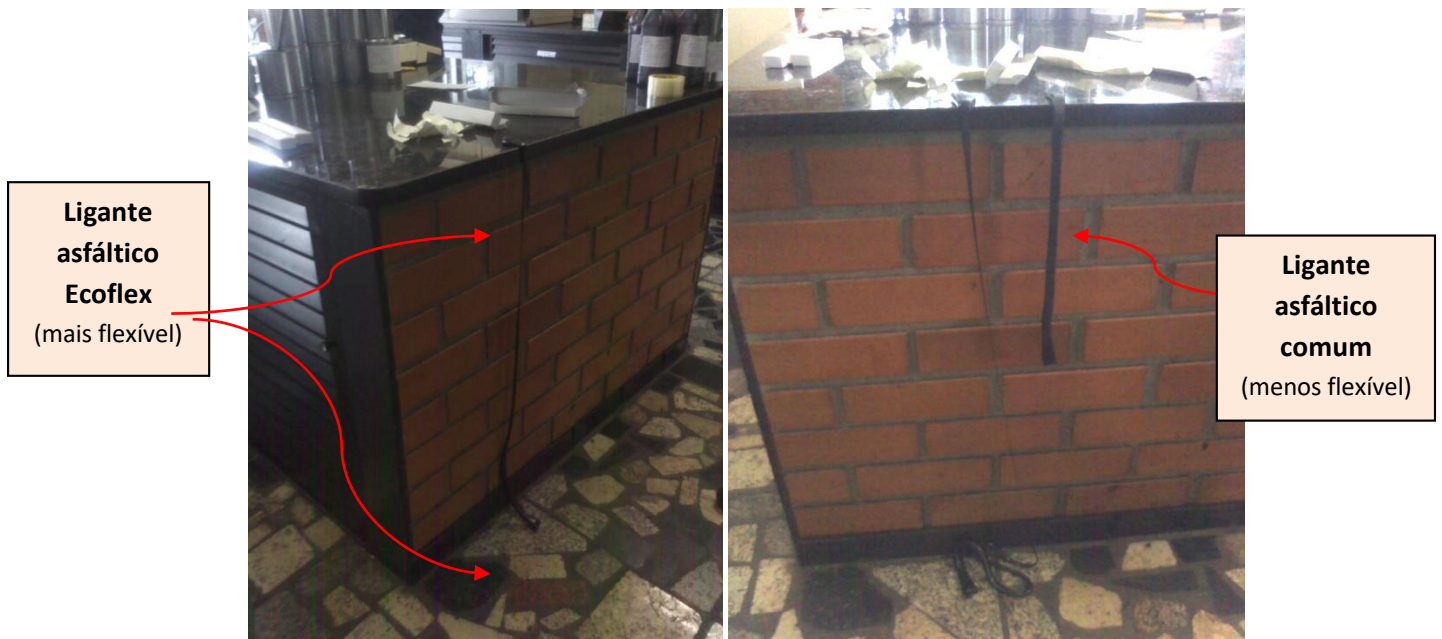
Figura 2.11 – Comparação de Flexibilidade entre o Ecoflex e o comum (GRECA ASFALTOS)
