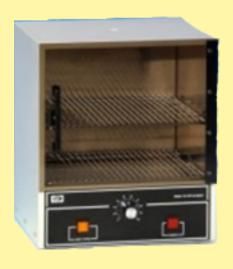
Diseñada para uso en laboratorios que requieren un método fiable para la incubación de medios de cultivo, kits de prueba y muchos otros procesos biológicos. La convección por gravedad ofrece una buena uniformidad de la temperatura y estabilidad.
