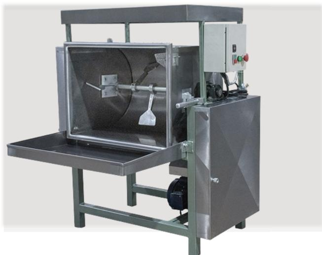
Perfecta no solo para la producción de masa para tortillas de maíz, sino también para la elaboración y mezcla de distintos alimentos. Fabricadas con bastidor de ángulo. Bote de acero inoxidable 430, flecha de acero al carbón, y paletas de aluminio. contamos con capacidad de: 25kg ,50kg, y 200kg. Perfecta para producción de masa de maíz y otros alimentos
