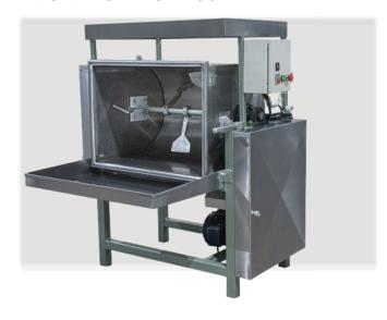
tortillas de maíz, sino también para la elaboración y mezcla de distintos alimentos. Fabricadas con bastidor de ángulo. Bote de acero inoxidable 430, flecha de acero al carbón, y paletas de aluminio. contamos con capacidad de: 25kg ,50kg, y 200kg. Perfecta para producción de masa de maíz y otros alimentos
