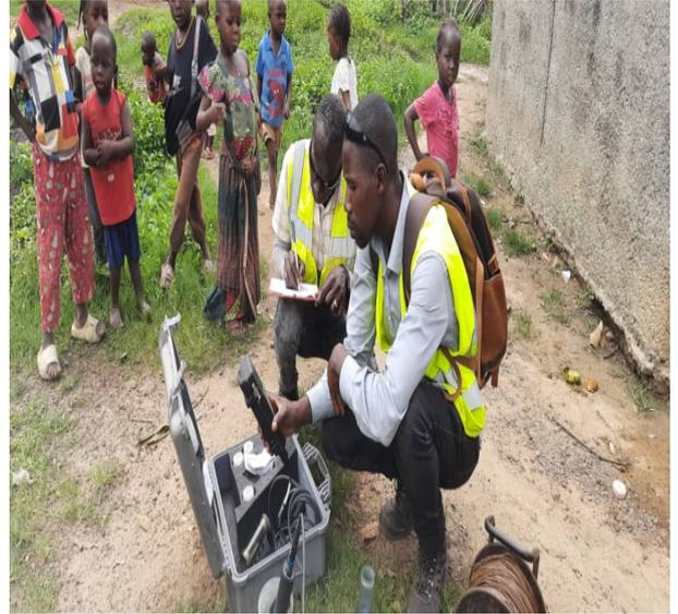
**Mésure la profondeur d'un point d'eau à Moribadou**
