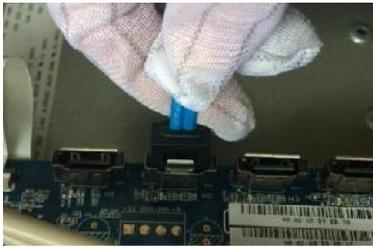
4. Conecte el otro extremo del cable del disco duro a la placa base.
