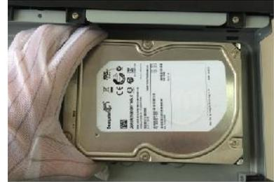
3. Coloque el disco duro sobre el dispositivo.
