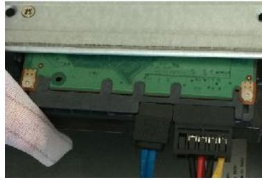
5. Use el cable de alimentación para conectar el disco duro a la placa base.
