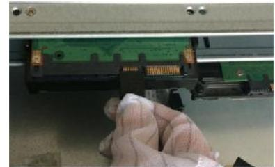
3. Conecte un extremo del cable del disco duro al disco duro.
