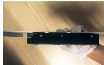
3. Coloque el disco duro sobre el soporte.
