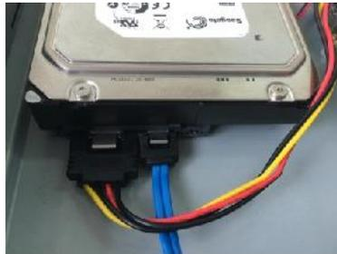
5. Use el cable de datos disco duro y el cable de alimentación para conectar el disco duro a la placa base.
