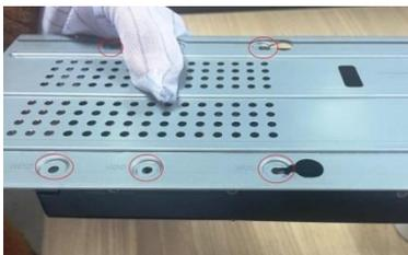
4. Alinee los agujeros del soporte con los orificios de los tornillos del disco duro.
