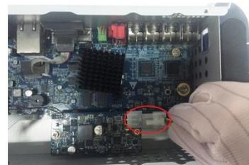
6. (Opcional) Pase el cable de la batería a través del agujero para conectarlo al puerto del cable.
