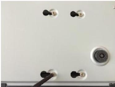
4. Gire el dispositivo para ver su parte trasera. Alinee los tornillos del disco duro con los agujeros en la parte trasera del dispositivo e introduzca los tornillos.
