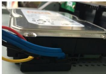
5. Use el cable de datos disco duro y el cable de alimentación para conectar el disco duro a la placa base.
