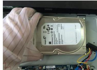
3. Coloque el disco duro sobre el dispositivo.
