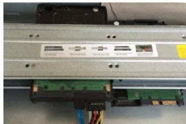
5. Use el cable de alimentación para conectar el disco duro a la placa base.
