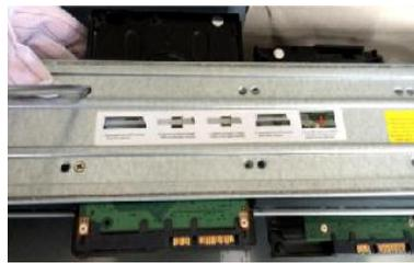
2. Fije el disco duro en el soporte. Saque el soporte superior si desea instalar el disco duro en el soporte inferior.
