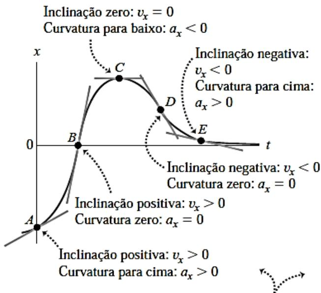
**Figura 2.14** (a) O mesmo gráfico  $xt$  indicado na Figura 2.8a. A velocidade é igual à inclinação do gráfico, e a aceleração é dada pela concavidade ou curvatura do gráfico. (b) Diagrama do movimento mostrando a posição, a velocidade e a aceleração da partícula em cada um dos instantes indicados no gráfico  $xt$ .
