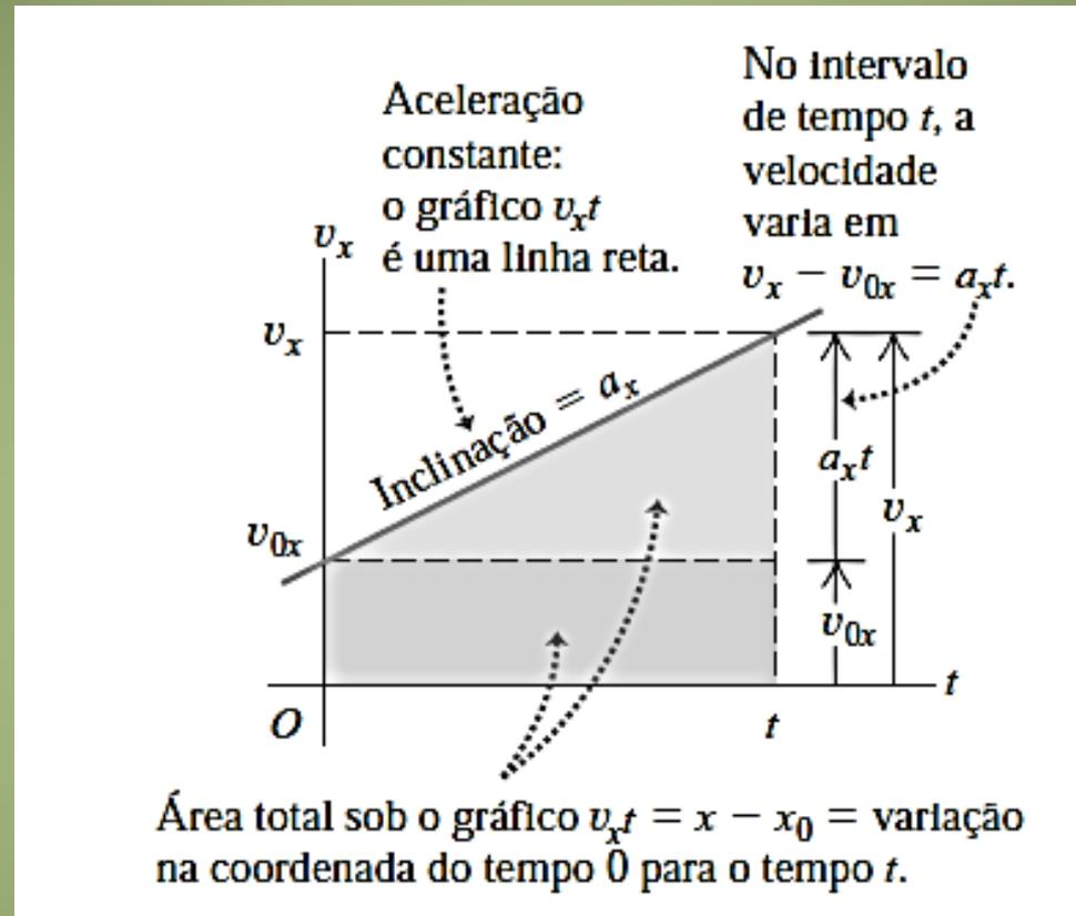
**Figura 2.17** Gráfico da velocidade *versus* tempo ( $v_x t$ ) para uma partícula que se move em linha reta com aceleração constante positiva  $a_x$ . A velocidade inicial  $v_{0x}$  também é positiva neste caso.
