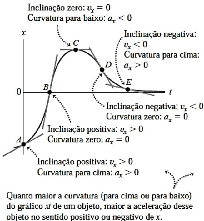
**Figura 2.14** (a) O mesmo gráfico  $xt$  indicado na Figura 2.8a. A velocidade é igual à inclinação do gráfico, e a aceleração é dada pela concavidade ou curvatura do gráfico. (b) Diagrama do movimento mostrando a posição, a velocidade e a aceleração da partícula em cada um dos instantes indicados no gráfico  $xt$ .
