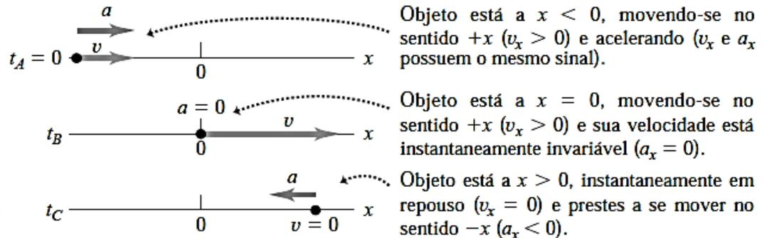
**Figura 2.14** (a) O mesmo gráfico  $xt$  indicado na Figura 2.8a. A velocidade é igual à inclinação do gráfico, e a aceleração é dada pela concavidade ou curvatura do gráfico. (b) Diagrama do movimento mostrando a posição, a velocidade e a aceleração da partícula em cada um dos instantes indicados no gráfico  $xt$ .
