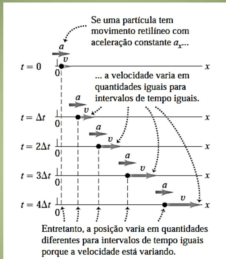
**Figura 2.15** Diagrama do movimento para uma partícula que se move em linha reta na direção positiva de  $x$  com aceleração constante positiva  $a$ . A posição, a velocidade e a aceleração são indicadas em cinco intervalos de tempo iguais..
