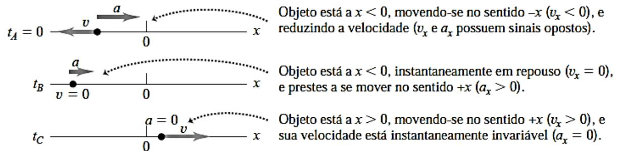
**Figura 2.13** (a) Gráfico  $v_x t$  do movimento de uma partícula. A inclinação da tangente em qualquer ponto é igual à aceleração do ponto considerado. (b) Diagrama do movimento mostrando a posição, a velocidade e a aceleração da partícula em cada um dos instantes indicados no gráfico  $v_x t$ .
