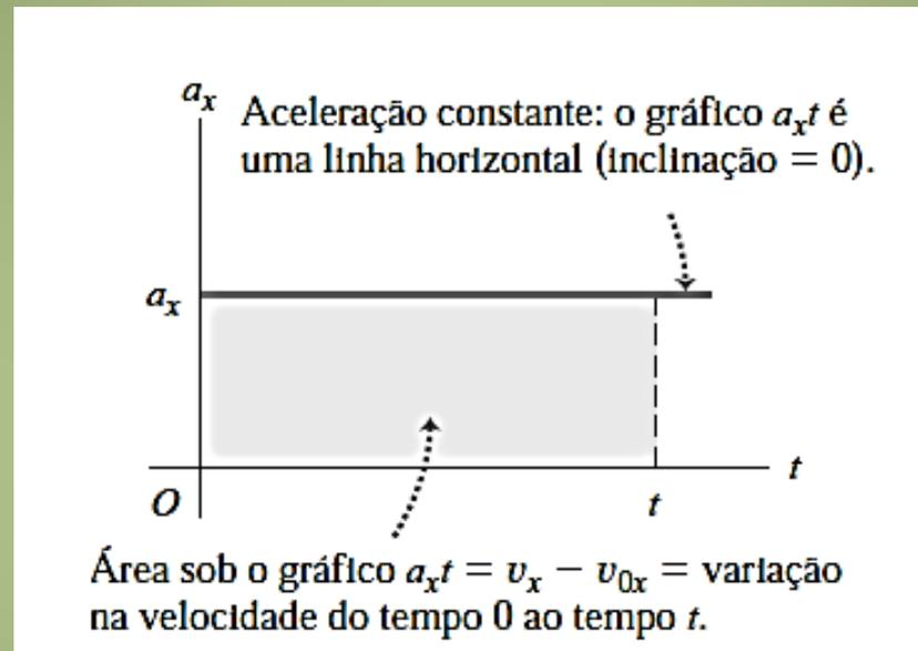
**Figura 2.16** Gráfico da aceleração *versus* tempo ( $at$ ) para uma partícula que se move em linha reta com aceleração constante positiva  $ax$ .
