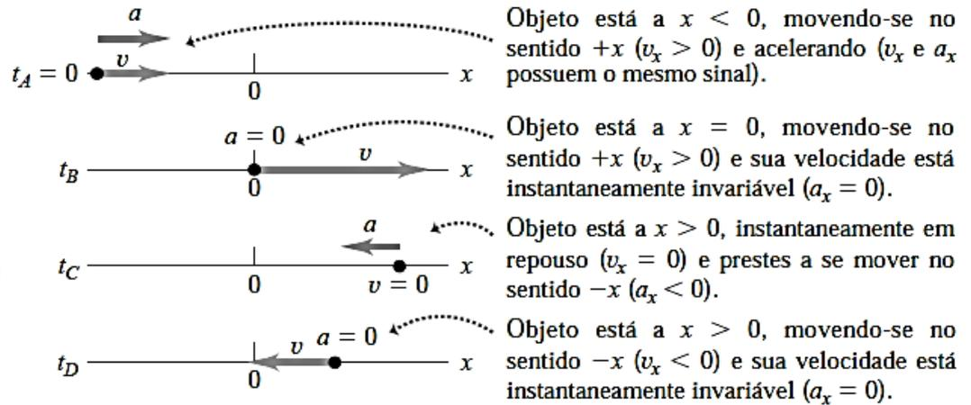
**Figura 2.14** (a) O mesmo gráfico  $xt$  indicado na Figura 2.8a. A velocidade é igual à inclinação do gráfico, e a aceleração é dada pela concavidade ou curvatura do gráfico. (b) Diagrama do movimento mostrando a posição, a velocidade e a aceleração da partícula em cada um dos instantes indicados no gráfico  $xt$ .
