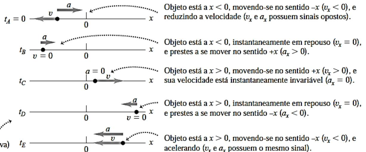
**Figura 2.13** (a) Gráfico  $v_x t$  do movimento de uma partícula. A inclinação da tangente em qualquer ponto é igual à aceleração do ponto considerado. (b) Diagrama do movimento mostrando a posição, a velocidade e a aceleração da partícula em cada um dos instantes indicados no gráfico  $v_x t$ .
