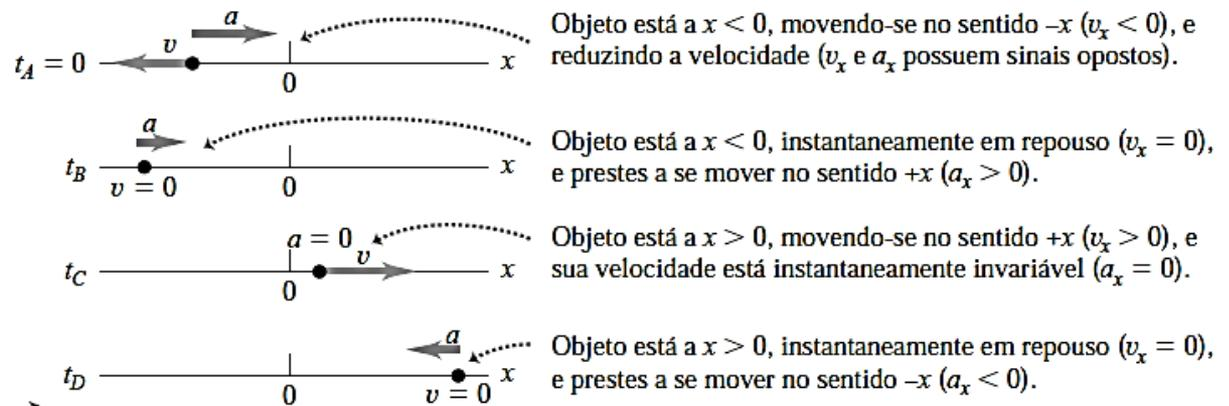
Objeto está a  $x < 0$ , movendo-se no sentido  $-x$  ( $v_x < 0$ ), e reduzindo a velocidade ( $v_x$  e  $a_x$  possuem sinais opostos).
