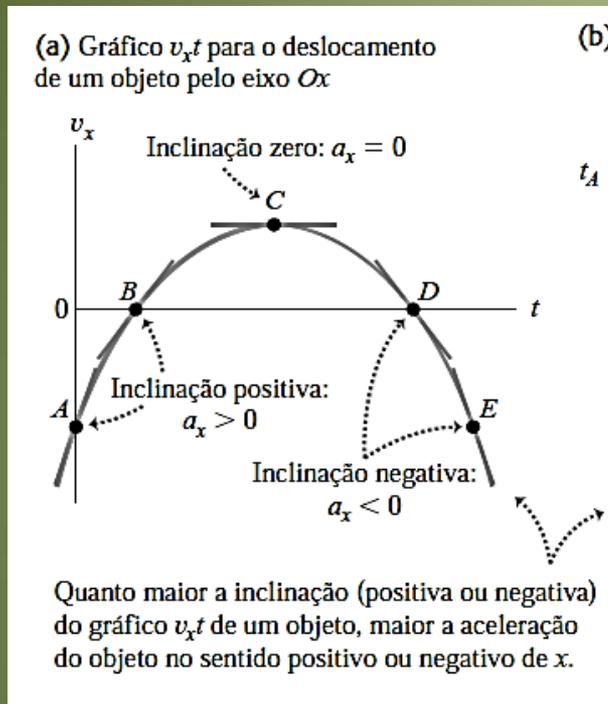
**Figura 2.13** (a) Gráfico  $vxt$  do movimento de uma partícula. A inclinação da tangente em qualquer ponto é igual à aceleração do ponto considerado. (b) Diagrama do movimento mostrando a posição, a velocidade e a aceleração da partícula em cada um dos instantes indicados no gráfico  $vxt$ .
