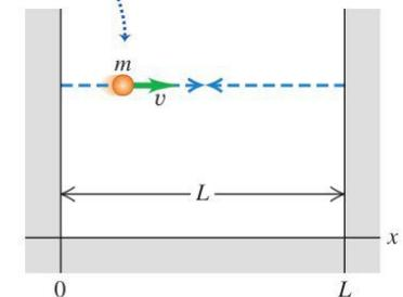
**Figura 40.9** A função energia potencial de uma partícula em uma caixa.
