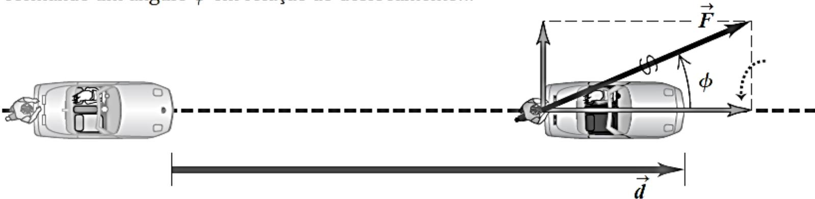
**Figura 6.3** O trabalho realizado por uma força constante que forma um ângulo em relação ao deslocamento.
