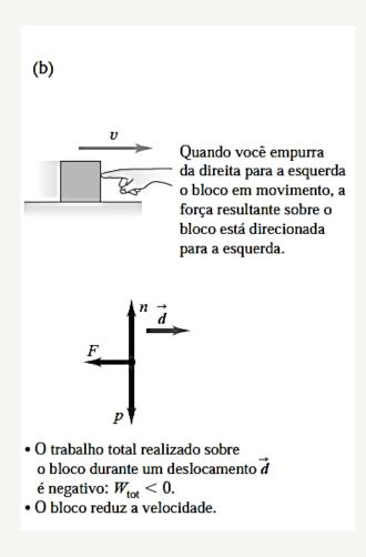
**Figura 6.8** A relação entre o trabalho total realizado sobre um corpo e a variação da velocidade escalar do corpo.
