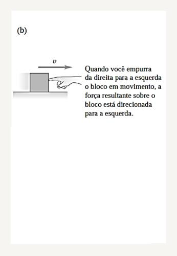
**Figura 6.8** A relação entre o trabalho total realizado sobre um corpo e a variação da velocidade escalar do corpo.
