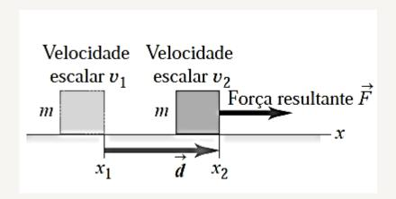
Figura 6.9 Uma força resultante constante realiza um trabalho sobre um corpo.
