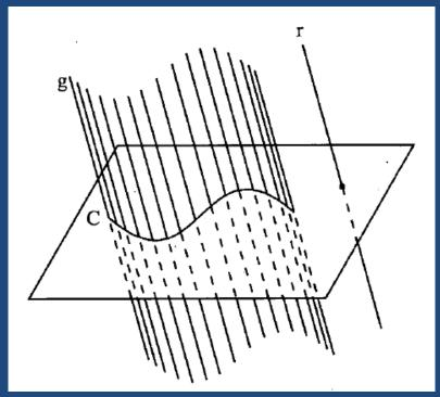
Seja a parábola  $x^2 = 2y$  e z = 0, tomando-se uma reta geratriz paralela ao eixo oz, a superfície cilíndrica estará ao longo deste eixo.
