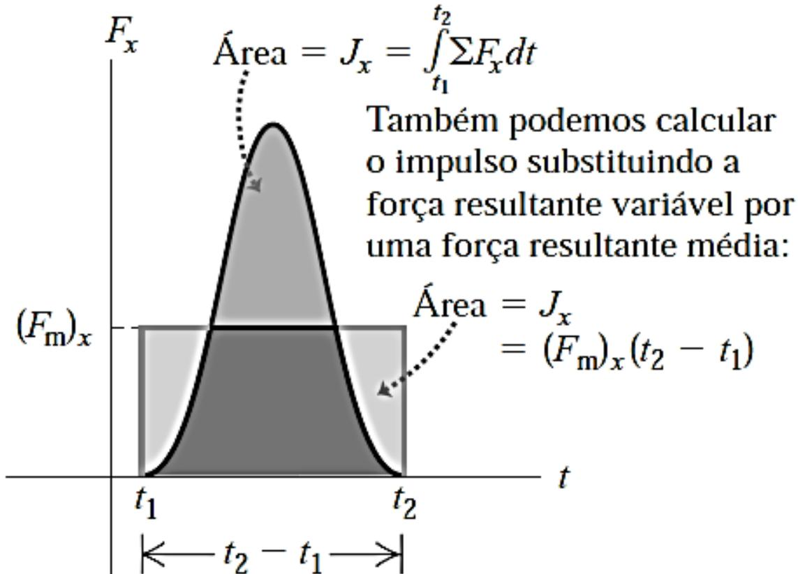
**Figura 8.3** O significado da área sob um gráfico  $\Sigma F_x$  versus  $t$ .
