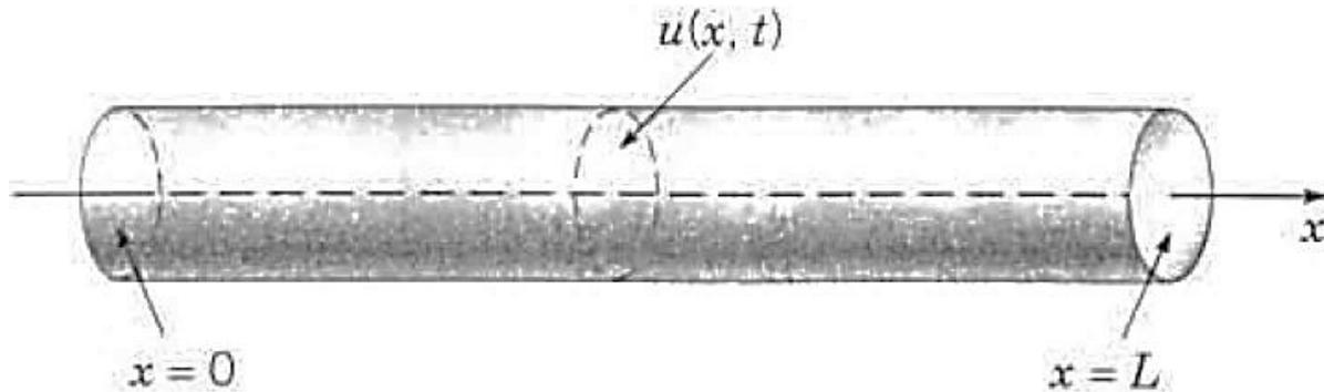
Figura 10.5.1 Uma barra sólida condutora de calor.
