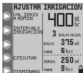
Figura 14A. Menú AJUSTAR IRRIGACIÓN, modo intermitente.
