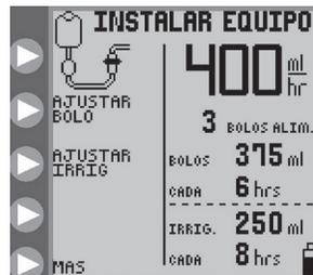
**Figura 5B. CARGAR SET pantalla inicial del menú del modo de alimentación intermitente (EZMODE no está activado).**
