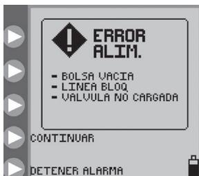
Figura 28. Pantalla de error de alimentación.
