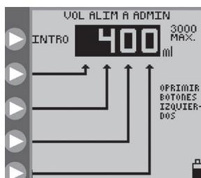
Figura 11C. Configuración del Volumen para alimentación a administrar.
