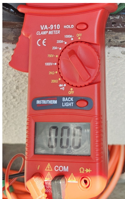
Figura 1.2: Detalhe da chave rotativa e dos bornes V, COM e \Omega .
