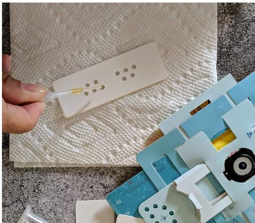
Foldscope é um microscópio individual, extremamente portátil, durável com clareza óptica de microscópio padrão (ampliação de 140X e resolução de 2 microns). Com ele há a transformação do aluno em agente de elaboração do próprio conhecimento, rompendo o paradigma de aluno passivo em seu processo de aprendizagem.
