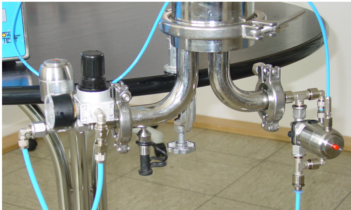
Установка "it-flush-T" с автоматическим режимом "замачивание" предназначена для подсоединения к Т-образному фильтродержателю.
