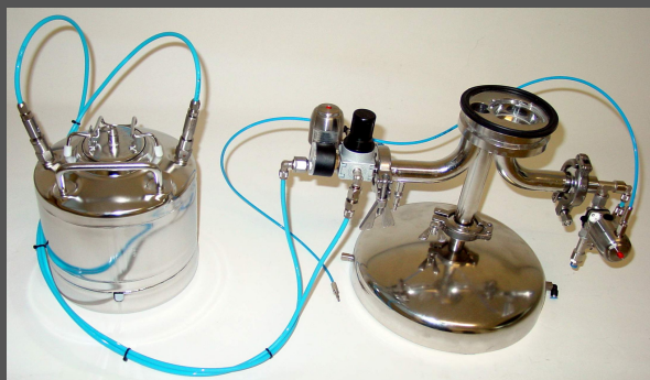
"it-flush-T" - для подсоединения к T-образному фильтродержателю
