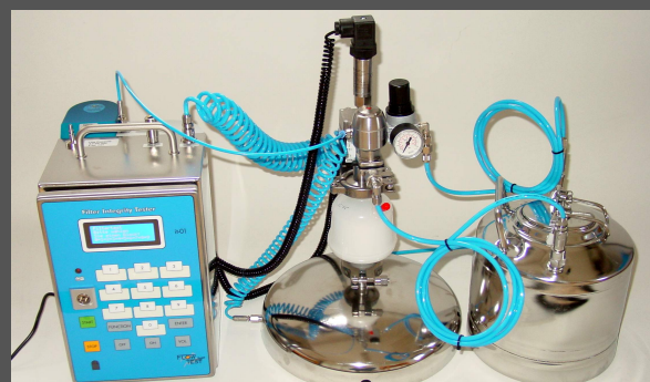
"it-flush-caps" - для тестирования фильтров капсульного типа
