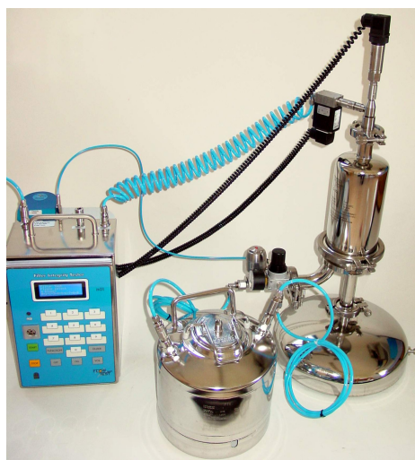
"it-flush" - совместно с прибором для проверки целостности мембранных фильтров "it-01"
