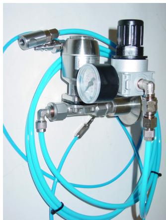
Eingangsteil mit GEMÜ-Ventil, Druckregler, Manometer, Versorgungsschläuche und TC-Anschluß
