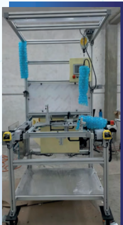
Estación de atornillado con giro 180°. DENSO
