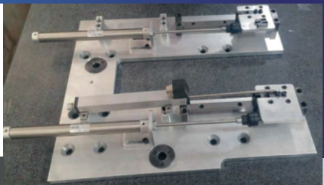
Diseño y fabricación de jigs de medición con certificación dimensional avalados ante la EMA.
