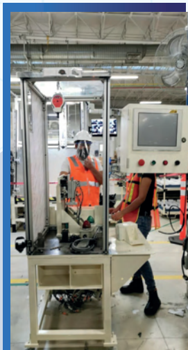
Estación de atornillado Motor-Ventilador. DENSO
