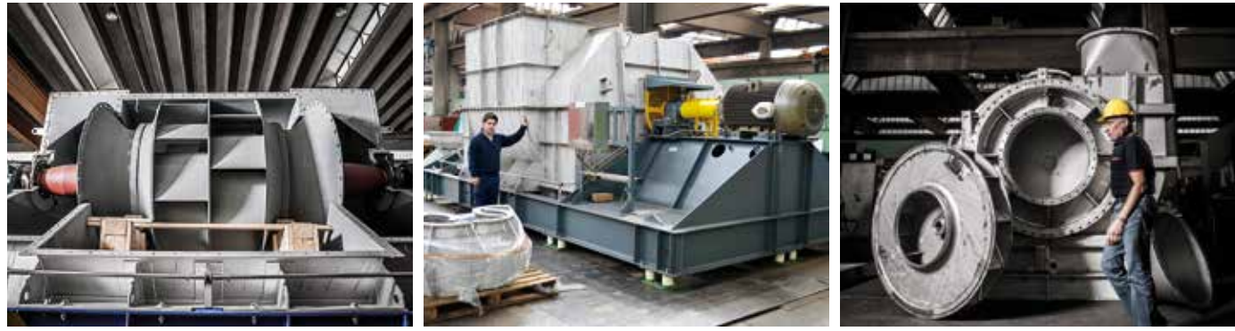
ID FAN - H2 PLANT ID FAN - ETHYLENE PLANT CO 2 BOOSTER FAN - UREA
