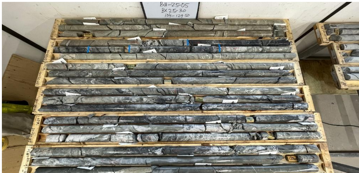
Foto 1: Mineralisierter Abschnitt aus Bohrloch BH-25-05. Beachten Sie, dass in diesem Loch der Stibnit über 20 Meter angetroffen wurde.
