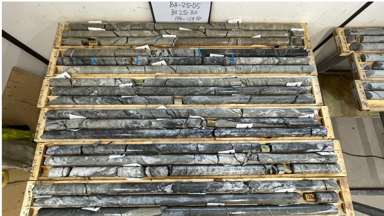
Foto 3: Bohrloch BH-25-05. Hervorzuheben ist, dass in einer Tiefe von 106 Metern bis 129 Metern über 20 Meter mit massiven und stibnithaltigen Brekzien vorliegen.
