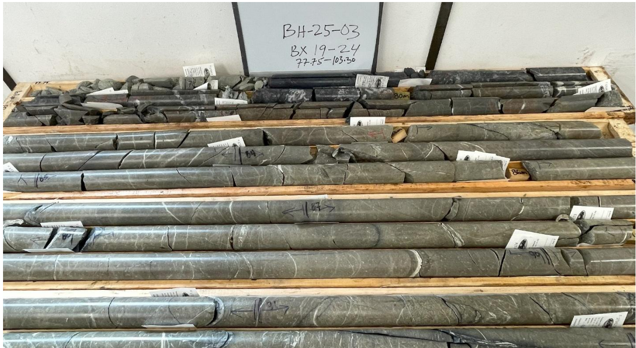
Foto 1: Bohrloch BH-25-03. Massive antimonhaltige Stibnitmineralisierung in Schluffstein. Anmerkung: Die dunklen Abschnitte enthalten eine Antimonmineralisierung.
