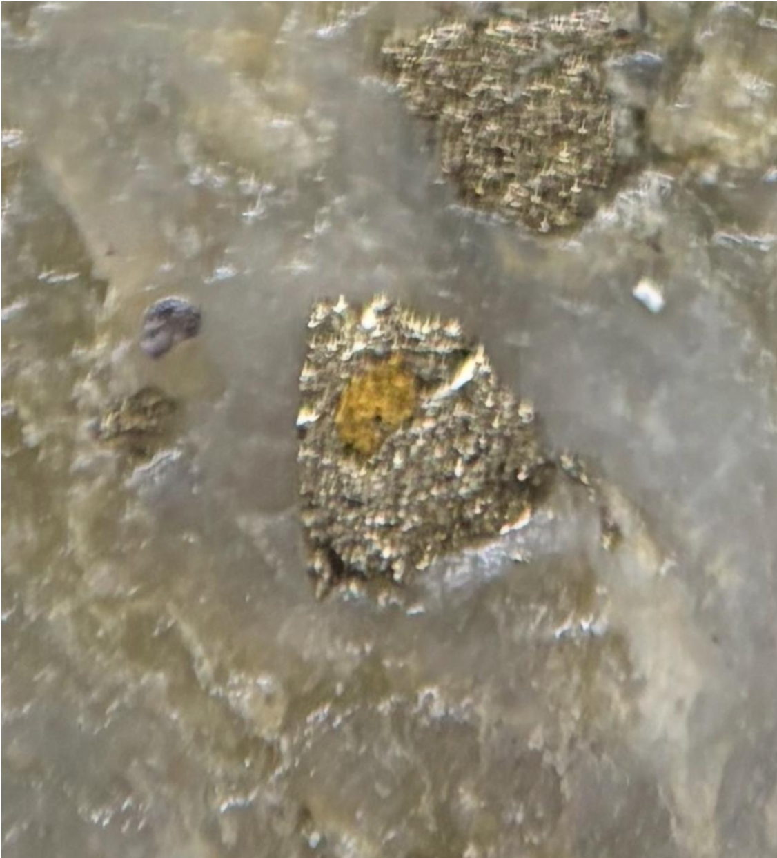
Foto 3: In Pyrit enthaltenes Gold in Bohrloch BHC-26-13 in 165,85 m Tiefe.
