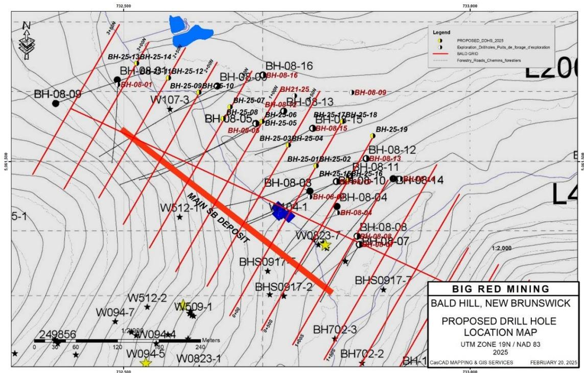
Abbildung 1: Standorte der geplanten Bohrungen durch ATMY (BH-25-01 etc.) und frühere Bohrungen (BH-08 -01 etc.), sowie Oberflächenprojektion der Mineralisierung bei der Main Zone.
