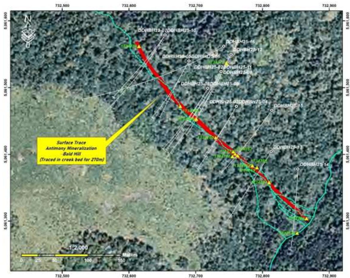
Abbildung 1: Standorte der Bohrlöcher in der Main Zone des Antimon-Projekts Bald Hill. Die gelben Dreiecke symbolisieren die Stellen mit massivem Stibnit an der Oberfläche. Die Oberflächenverläufe der Mineralisierung sind rot dargestellt, während die Bohrlöcherstandorte durch Kreise gekennzeichnet sind. Hinweis: Aus Gründen der Übersichtlichkeit sind nur die
