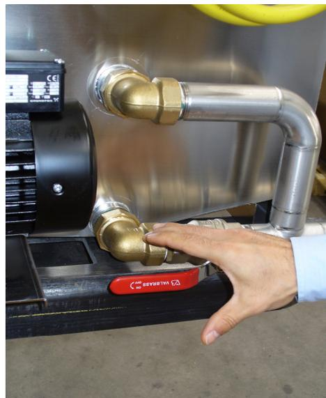
**Una volta aperta la valvola aspettare qualche minuto per permettere all'acqua di defluire completamente.**
