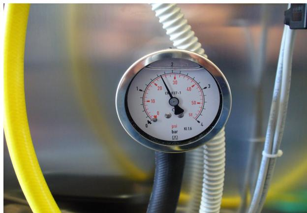
***se la macchina è in corretta efficienza il manometro sopra la pompa deve lavorare ad una pressione circa di 1,8 bar.***
