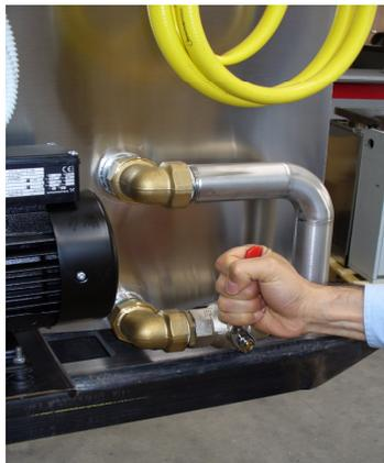
**Ruotare la leva in posizione orizzontale per aprire la valvola**
