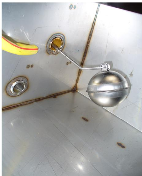
**direzionare il getto dell'acqua sul livellostato che si trova sulla parte bassa a sinistra della macchina, pulire accuratamente il foro in cui si trova il braccetto e la palla galleggiante, verificare con una mano che il livellostato abbia il gioco su e giù.**
