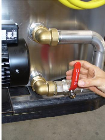
**Scaricare l'acqua all'interno della vasca, per svuotare la macchina dalla fuliggine che si è accumulata all'interno dell'abbattitore. Questa operazione deve essere effettuata prima di accendere il forno a macchina spenta.**
