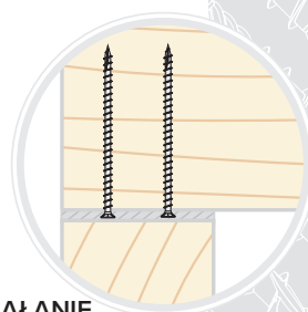
PRZECIWDZIAŁANIE ŚCISKANIA PROSTOPADŁEGO DO WŁÓKIEN
