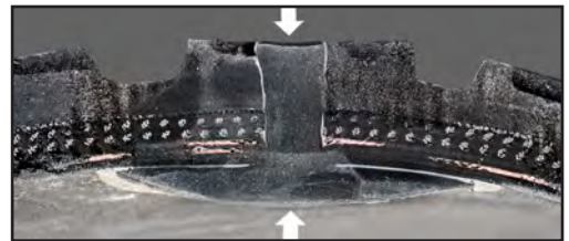
Reparación adecuada del Neumático
