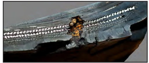
Reparación inadecuada del Neumático
