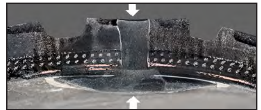
Reparación adecuada del Neumático
