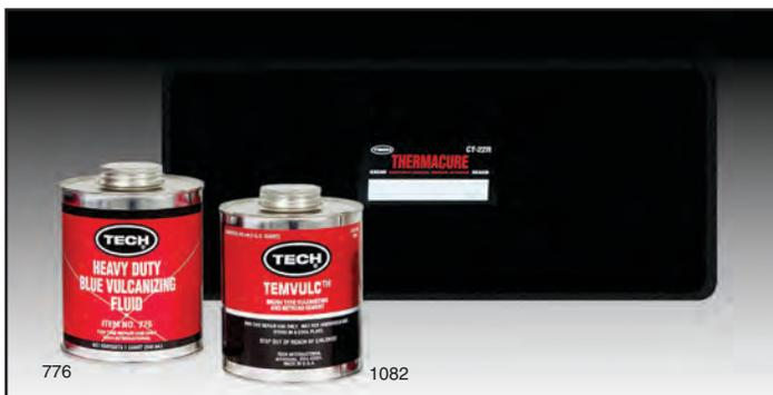
Los parches Centech Thermacure con refuerzo Aramid son recomendados cuando los neumáticos son curados con vulcanizadores, prensas, moldes por secciones o sistemas Monaflex. Las unidades Thermacure se deben instalar con Cemento Azul para trabajo pesado una vez ha sido aplicado y curado el relleno de caucho. En aplicaciones con calor el parche debe instalarse con Cemento Negro Tem-Vulc Tech.
