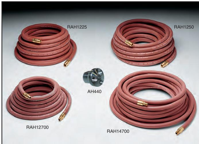
Las mangueras Tech están fabricadas con un caucho EPDM duro, que ofrecen una presión de trabajo de 300 psi (2068 kpa). El rango de temperatura de trabajo recomendada es de -40°F (-40°C) a +185°F (85°C).
