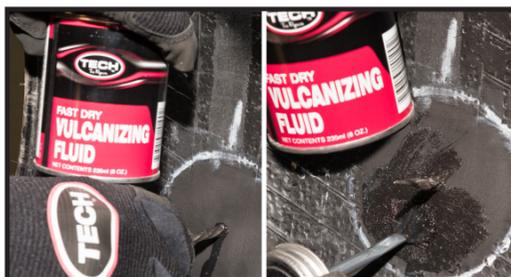
**6.** Usando una herramienta de cemento espiral en dirección de reloj, aplique química Vulcanizing Fluid # 760 a la lesión 3 - 5 veces. Aplique una capa delgada y uniforme a la superficie pulida y deje secar de 3 a 5 minutos. Tiempo adicional puede ser requerido en condiciones frías o húmedas.
