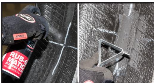
**2.** Para eliminar los contaminantes, limpie previamente 2 o 3 veces el revestimiento interior con limpiador de caucho Rub-O-Matic (#704A) y un raspador.
