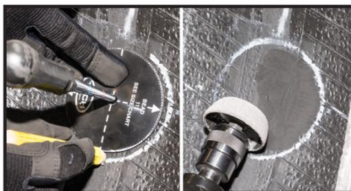
**3.** Dibuje el perímetro de la sección a raspar. Con un raspador de baja velocidad (máx. 5000 RPM) y la apropiada rueda para revestimientos interiores raspe el área dibujada.
