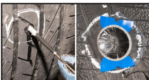
**8.** Desde el exterior del neumático agarre el alambre con unas pinzas y tire del vástago a través del neumático hasta que la tapa forme una leve protuberancia.
