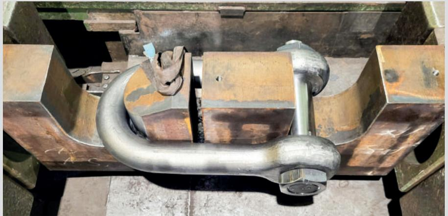
Prueba de carga (2 x CLT) utilizando un sistema de liberación rápida.
