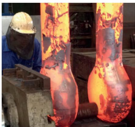
Las dimensiones de forja del arco se controlan y ajustan
