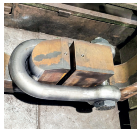
Manilhas passam por teste de carga (teste-munho de classificadora sob demanda)
