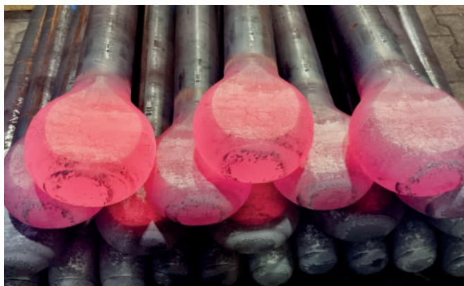
Processo de forjamento sem desperdício: olhais forjados por recalque
