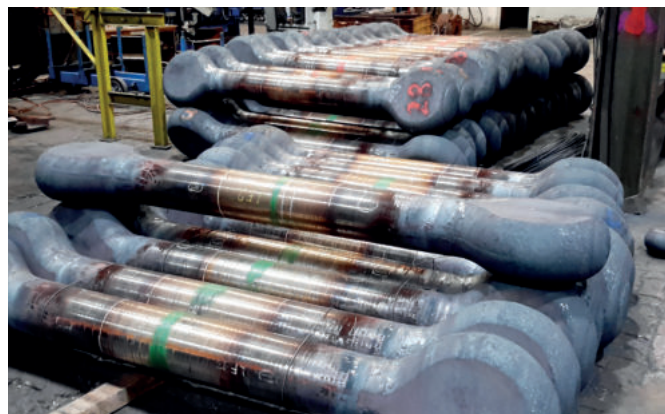
Processo de forjamento sem desperdício: ‘dog bones’
