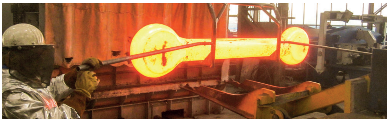
Processo de forjamento sem desperdício: dos „dog bones” forjam o corpo
