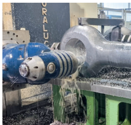
Manilhas e pinos são usinados com CNC internamente
