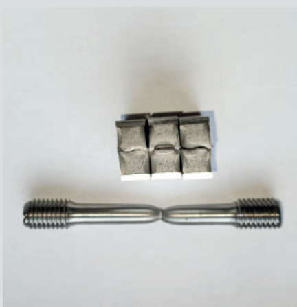
Ensaio mecânico é realizado para cada lote de produção e assegura a rastreabilidade individual de cada manilha
