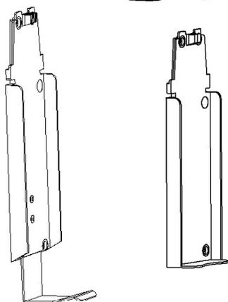
2. Fixer le support mural sur la surface choisie, en utilisant les vis et les chevilles fournies. Laisser un espace libre de 30 cm sous l'extrémité inférieure du support mural pour faciliter la mise en place et le retrait de la bouteille.
