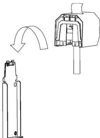
4. Lorsque le bloc de distribution est parfaitement enclenché, resserrer les vis situées sous le bloc.
