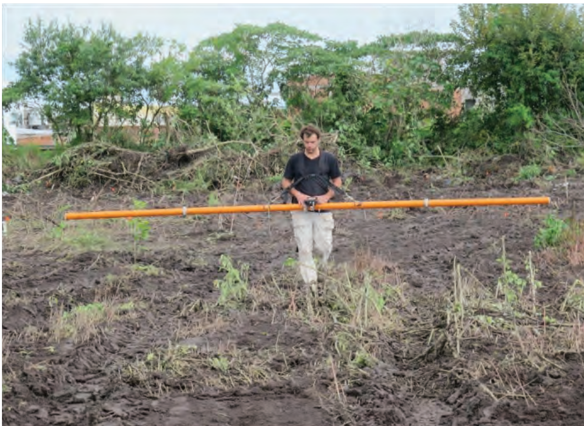
Foto 2. Uso de un método electromagnético en el campo, que tiene una barra con bobinas de cable en el interior. El cable da corriente a una determinada frecuencia y circula por el suelo y recibe señal desde el otro lado. La proporción de la señal que emite y que recibe es proporcional a la conductividad eléctrica del suelo (Foto: Santiago Perdomo).
