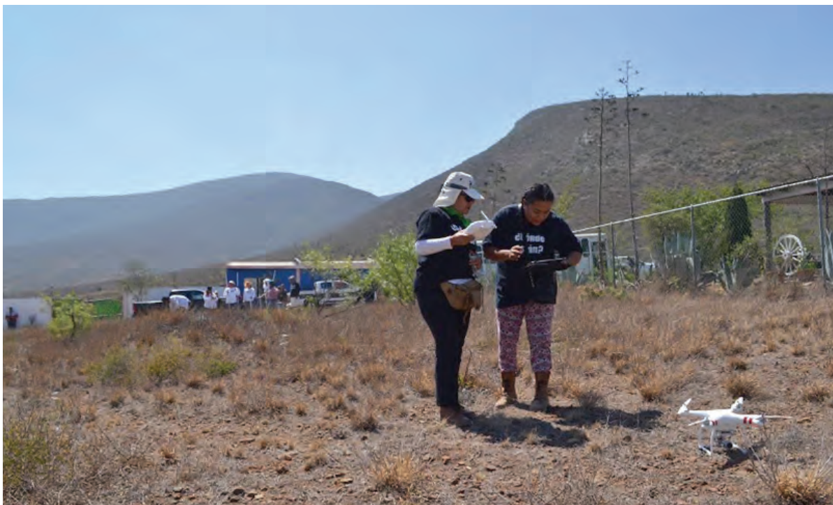
Foto 3. Integrantes de FUNDENL durante una búsqueda en campo utilizando un dron Phantom 3, con el que obtienen imágenes que les permiten generar un modelo 3D en una aplicación llamada QGIS. Este modelo 3D permite a FUNDENL estudiar las características de un área de interés para investigar si estas podrían estar relacionadas con la presencia de restos (Foto: Lili López).
