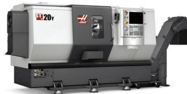
Torno CNC integrado con eje C, eje Y, contrapunto y herramientas motorizadas que permiten mecanizado radial y axial en una sola operación.
