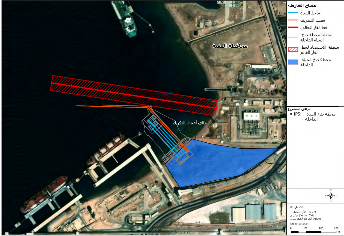
الشكل 14 مخطط تخطيطي إرشادي لمنشآت السحب والتصريف البحري ومحطة ضخ السحب
