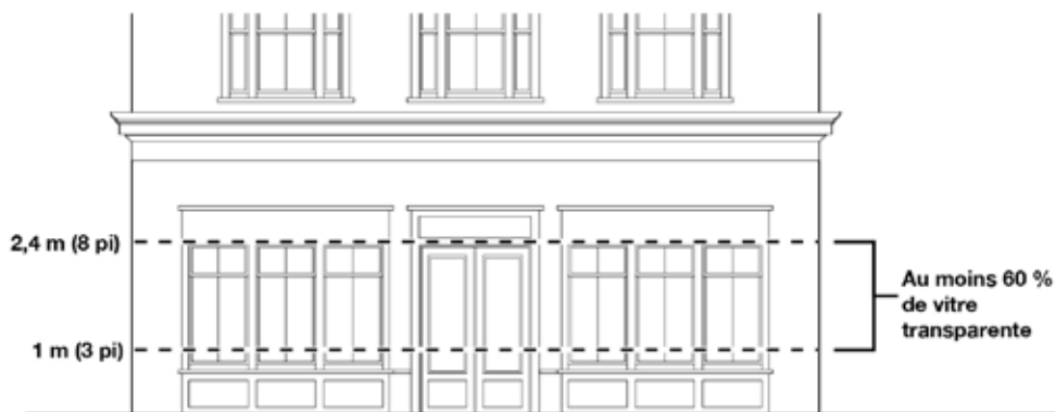
Figure 3. Commerces de détail et établissements de service au rez-de-chaussée présentant, sur leurs façades, la quantité minimale de vitres transparentes
