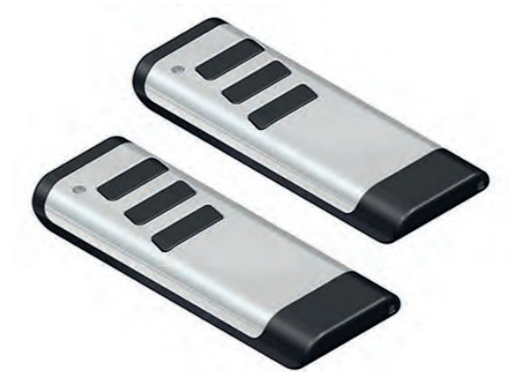
Handzender met 3 kanalen, 433 MHz en KeeLoq-wisselcode, AES 128-bit
