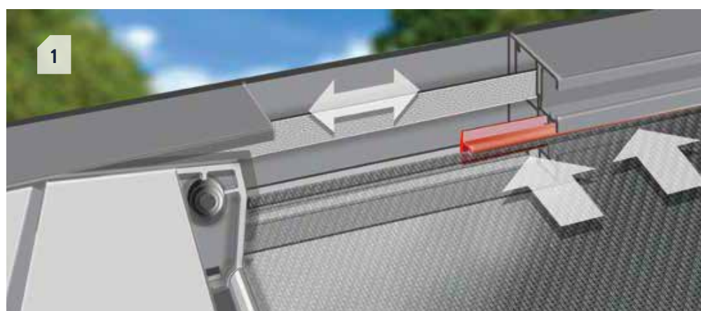
Het dakdoek wordt strak in de geleiders gehouden dankzij de continue spanning van de ZIP-screentechnologie.
