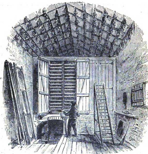
Fig. 1.— Séchoir pour les végétaux destinés à être pulvérisés.
