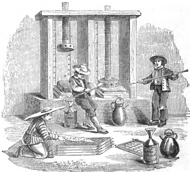
Fig. 53. — Presse à écrou pour comprimer les toiles huilées et exprimer l'huile parfumée.
