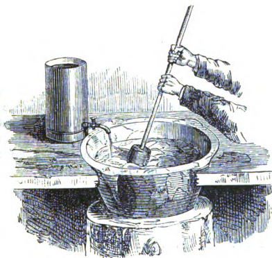
Fig. 67. — Versoir et mortier pour la fabrication des émulsines.
