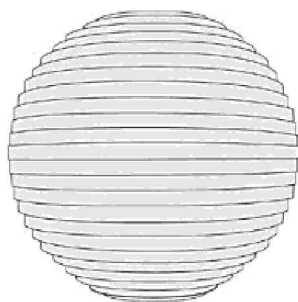
Fig. 2.02 Une sphère peut être reconstituée en empilant des disques de différentes tailles.
