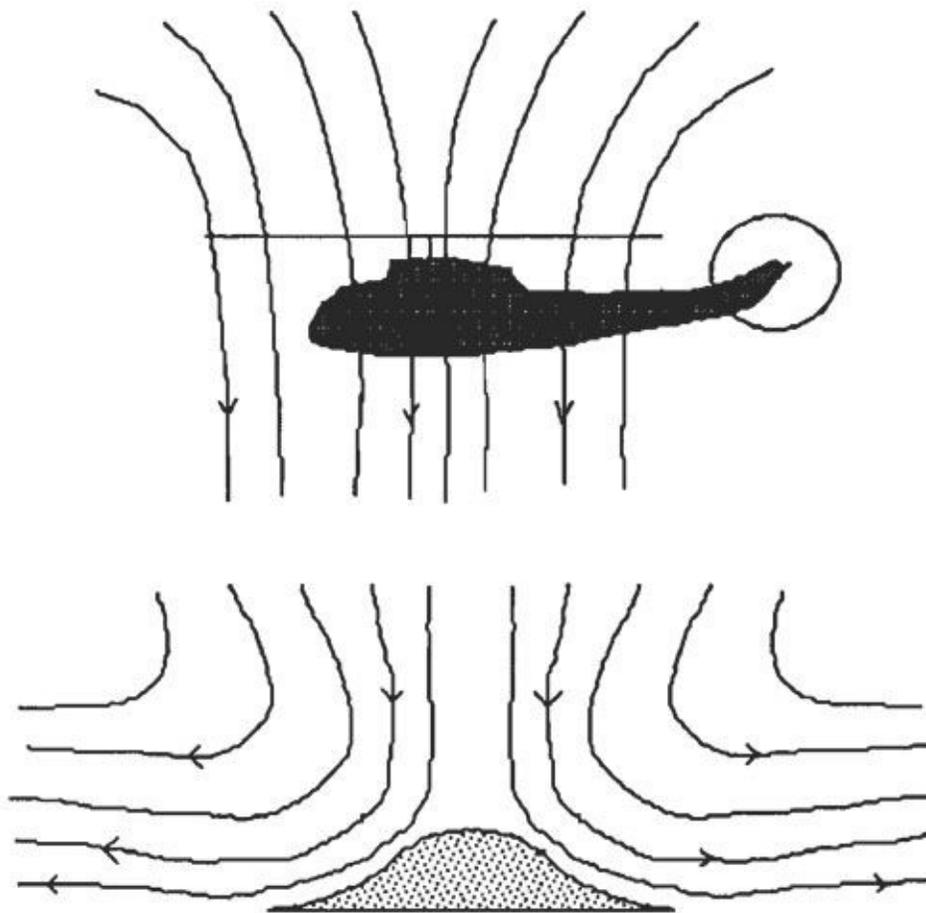
*Écoulement d'air produit par un aérodyne MHD en sustentation au-dessus du sol*
