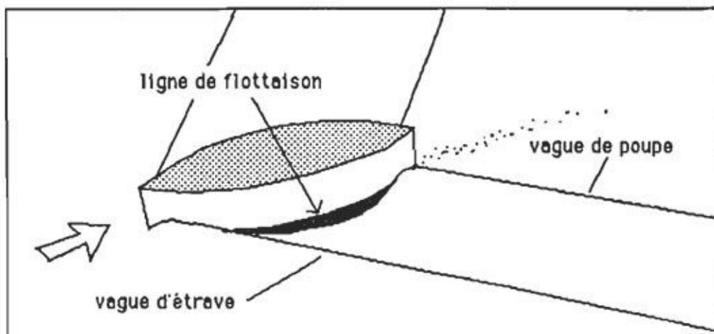
*Représentation schématique du système des vagues d'étrave et de poupe autour d'un navire « fendant les flots »*
