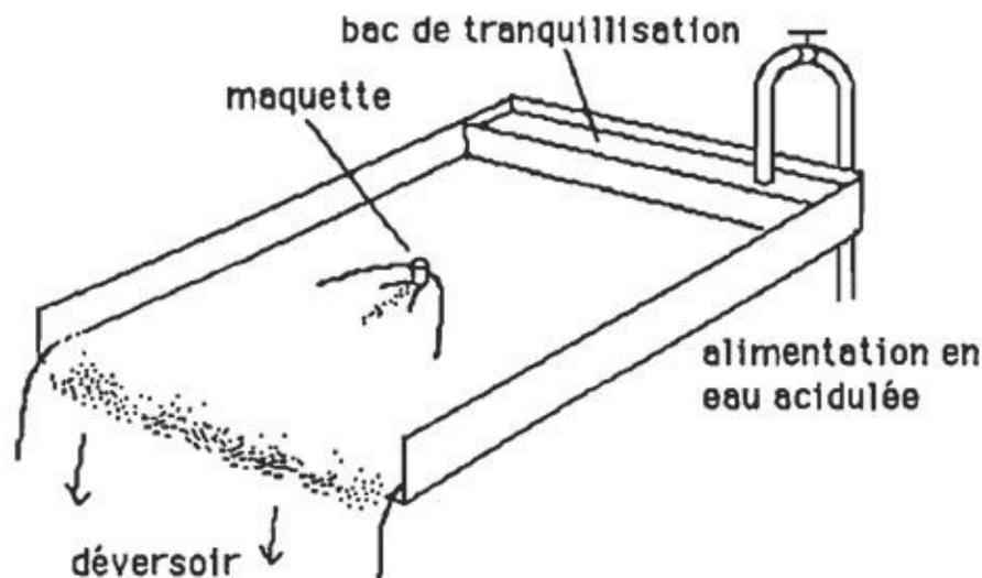
*Le dispositif de simulation hydraulique*
