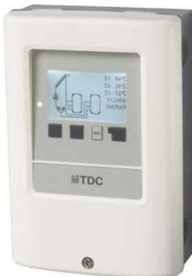
La centralina elettronica MTDC permette di controllare agevolmente impianti solari e di riscaldamento con 2 circuiti e 1÷2 serbatoi di accumulo, grazie alla scelta fra 25 differenti varianti di impianto. Munita di un display retroilluminato da 124x64 pixel dalla grafica intuitiva, che mostra in tempo reale le condizioni dell'impianto tramite un pittogramma schematico.
