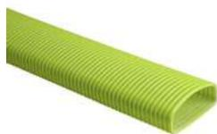
Condotta in PE-G-GNR semiovale a doppio strato, resistente alle aggressioni chimiche del cemento, ed un carico massimo di 200 mm di massetto in cemento, piegabile orizzontalmente e verticalmente.
