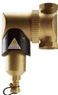
Separatore ad alta efficacia con corpo in ottone che elimina le particelle magnetiche e amagnetiche dagli impianti di riscaldamento e raffreddamento. Il defangatore si monta in linea e lavora in continuo eliminando anche le particelle più fini dal liquido dell'impianto. Il potente magnete amovibile agisce verso l'interno garantendo una separazione estremamente efficace. Il raccordo orientabile facilita il collegamento alle tubazioni (orizzontale, verticale, diagonale).
