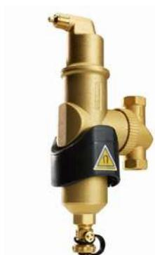
Rimuove efficacemente tutta l'aria e le microbolle circolanti, anche le particelle molto piccole (5 µm). Riduce significativamente la necessità di spurgare l'impianto manualmente. L'installazione deve avvenire preferibilmente nel punto più caldo dell'impianto. Include un magnete in ottone per una protezione aggiuntiva e un'efficace rimozione della magnetite.
