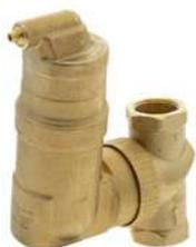
I separatori di microbolle d'aria, installati nel passaggio del flusso, permettono di eliminare l'aria in circolo e le microbolle dal liquido dell'impianto. Rimuovendo l'aria intrappolata, vengono ridotti i tempi di regolazione e di sfiato manuale ed evitate inutili interruzioni nel flusso dell'impianto. L'installazione deve avvenire preferibilmente nel punto più caldo dell'impianto.
