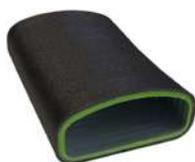
Condotta in PE-G-GNR semiovale a doppio strato, resistente alle aggressioni chimiche del cemento, ed un carico massimo di 200 mm di massetto in cemento, piegabile orizzontalmente e verticalmente.
