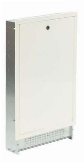
Corpo in lamiera zincata. Porta bianca smontabile con serratura ad intaglio piatto. Cornice con bordo piano regolabile in profondità. Rete portaintonaco per le parti intonacabili. Ferramenta necessaria per il completo assemblaggio.
