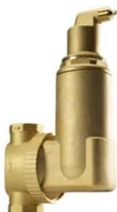
I separatori di microbolle d'aria, installati nel passaggio del flusso, permettono di eliminare l'aria in circolo e le microbolle dal liquido dell'impianto. Rimuovendo l'aria intrappolata, vengono ridotti i tempi di regolazione e di sfiato manuale ed evitate inutili interruzioni nel flusso dell'impianto. L'installazione deve avvenire preferibilmente nel punto più caldo dell'impianto.
