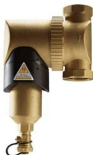
Separatore ad alta efficacia con corpo in ottone che elimina le particelle magnetiche e amagnetiche dagli impianti di riscaldamento e raffrescamento. Il defangatore si monta in linea e lavora in continuo eliminando anche le particelle più fini dal liquido dell'impianto. Il potente magnete amovibile agisce verso l'interno garantendo una separazione estremamente efficace. Il raccordo orientabile facilita il collegamento alle tubazioni (orizzontale, verticale, diagonale).
