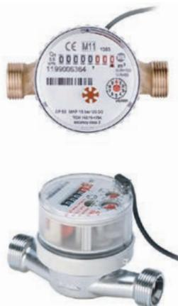
Il DN15 è un contatore per acqua a getto unico a quadrante asciutto, dotato di un emettitore di impulsi per essere collegato ad elettroniche di comunicazione M-Bus.
