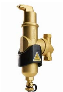
Rimuove efficacemente tutta l'aria e le microbolle circolanti, anche le particelle molto piccole (5  $\mu$ m). Riduce significativamente la necessità di spurgare l'impianto manualmente. L'installazione deve avvenire preferibilmente nel punto più caldo dell'impianto. Include un magnete in ottone per una protezione aggiuntiva e un'efficace rimozione della magnetite.
