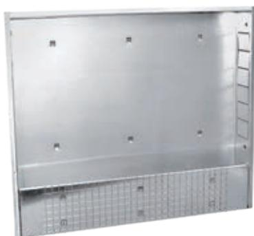
Cassetta di alloggiamento collettore, da incasso nella muratura, costruita in lamiera d'acciaio zincato, verniciata bianco RAL 9010. Completa di piedini di supporto regolabili in altezza da 630 a 700 mm. Predisposta con binario per il fissaggio collettori. **Profondità 110 mm.** Indicato per collettori con valvole di intercettazione a sfera e bocchettoni con termometro
