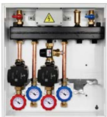
Cassetta con gruppo di rilancio 1 zona in alta temperatura + 1 zona miscelata ■ Cassetta dim. 450/500/160 ■ Attacchi generatore d.3/4" M ■ Attacchi circuito riscaldamento d. 3/4"F ■ Portata 2100 lt/h ■ Circolatore Grundfos UPM3 hybrid 14-70 erp per ogni zona diretta; 1300lt/h per la zona miscelata
