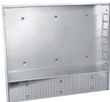
Cassetta di alloggiamento collettore, da incasso nella muratura, costruita in lamiera d'acciaio zincato, verniciata bianco RAL 9010. Completa di piedini di supporto regolabili in altezza da 630 a 700 mm. Predisposta con binario per il fissaggio collettori. **Profondità 90 mm.** Indicato per collettori senza valvole a sfera e termometri
