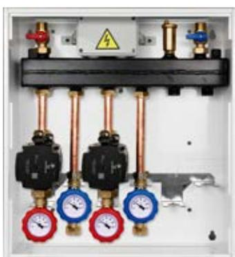
Cassetta con gruppo di rilancio 2 zone in alta temperatura ■ Cassetta dim. 450/500/160 ■ Attacchi generatore d.3/4" M ■ Attacchi circuito riscaldamento d. 3/4"F ■ Portata 2100 lt/h ■ Circolatore Grundfos UPM3 hybrid 14-70 erp per ogni zona
