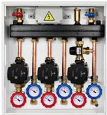
Cassetta con gruppo di rilancio 2 zone + 1 zona miscelata in alta temperatura ■ Cassetta dim. 450/500/160 ■ Attacchi generatore d.3/4" M ■ Attacchi circuito riscaldamento d. 3/4"F ■ Portata 2100 lt/h ■ Circolatore Grundfos UPM3 hybrid 14-70 erp per ogni zona diretta; 1300lt/h per la zona miscelata
