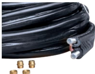
Tubo flessibile in acciaio inox AISI 316I, Ø 16, rivestito con guaina isolante spessore 14 mm, viene raccordato alle estremità con raccordi in ottone Ø 21,4/16, in versione doppio tubo con inserito il cavo schermato per il collegamento della sonda di temperatura. DIAMETRO ¾".
