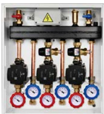
Cassetta con gruppo di rilancio 1 zona in alta temperatura + 2 zone miscelate ■ Cassetta dim. 450/500/160 ■ Attacchi generatore d.3/4" M ■ Attacchi circuito riscaldamento d. 3/4"F ■ Portata 2100 lt/h ■ circolatore Grundfos UPM3 hybrid 14-70 erp per ogni zona diretta; 1300lt/h per ogni zona miscelata
