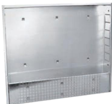
Cassetta di alloggiamento collettore, da incasso nella muratura, costruita in lamiera d'acciaio zincato, verniciata bianco RAL 9010. Completa di piedini di supporto regolabili in altezza da 630 a 700 mm. Predisposta con binario per il fissaggio collettori. **Profondità 150 mm.** Indicato per collettori con kit di regolazione e circolazione
