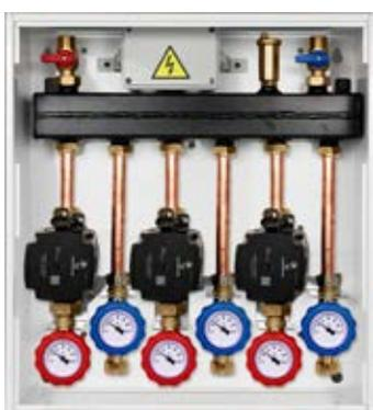
Cassetta con gruppo di rilancio 3 zone in alta temperatura ■ Cassetta dim. 450/500/160 ■ Attacchi generatore d.3/4" M ■ Attacchi circuito riscaldamento d. 3/4"F ■ Portata 2100 lt/h ■ Circolatore Grundfos UPM3 hybrid 14-70 erp per ogni zona
