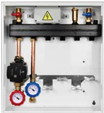
Cassetta con gruppo di rilancio 1 zona in alta temperatura ■ Cassetta dim. 450/500/160 ■ Attacchi generatore d.3/4" M ■ Attacchi circuito riscaldamento d. 3/4"F ■ Portata 2100 lt/h ■ Circolatore Grundfos UPM3 hybrid 14-70 erp
