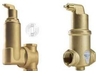
I separatori di microbolle d'aria, installati nel passaggio del flusso, permettono di eliminare l'aria in circolo e le microbolle dal liquido dell'impianto. Rimuovendo l'aria intrappolata, vengono ridotti i tempi di regolazione e di sfiato manuale ed evitate inutili interruzioni nel flusso dell'impianto. L'installazione deve avvenire preferibilmente nel punto più caldo dell'impianto.
