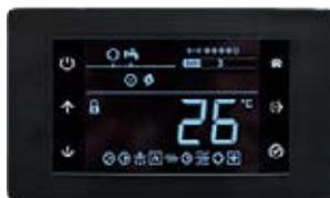
Comando remoto con funzione di termostato ambiente e programmatore orario. Display LCD touch-screen. Collegamento a filo con unità esterna
