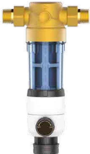
Filtri pulenti si dividono nelle versioni 3 e 4 caratterizzati da un sistema di raschiatura della superficie filtrante su entrambi i lati con la semplice rotazione della ruota inferiore. La simultanea apertura dello scarico consente la fuoriuscita dello sporco e la perfetta pulizia del filtro.
