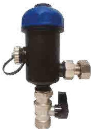
Filtro defangatore magnetico per impianti di riscaldamento realizzato in materiale plastico. Ideale per la rimozione dei fanghi e residui ferrosi dai circuiti di riscaldamento. La cartuccia filtrante è in grado di rimuovere i contaminati non magnetici mentre quelli magnetici sono attratti dal potente magnete.
