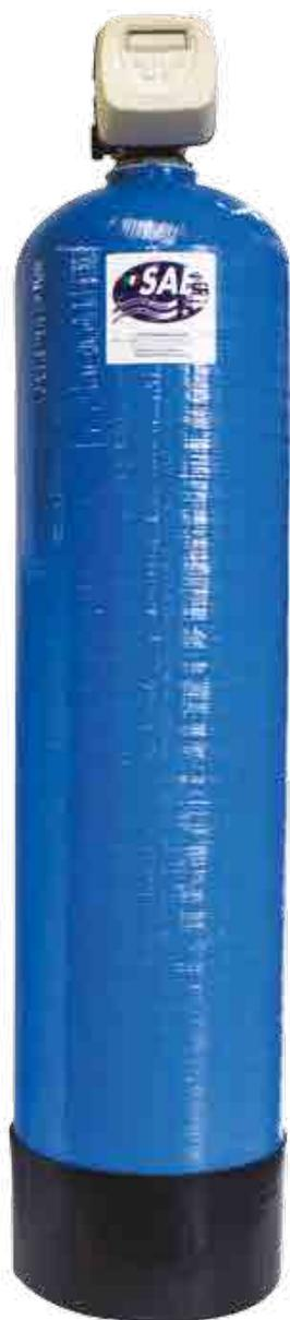
Filtri deferizzatori automatici costituiti da una bombola in vetroresina contenente vari materiali filtranti e deferizzanti e di una valvola automatica (rigenerazione a tempo) posizionata in testa, per il lavaggio del filtro. La portata dei filtri è in funzione del quantitativo di ferro contenuto nell'acqua. E' necessario posizionare, a monte del filtro, una vasca di raccolta di idonee dimensioni dove effettuare la clorazione dell'acqua.
