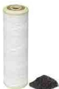
Le cartucce Cappa svolgono una doppia azione: filtrante (pre-filtrante), attraverso la superficie esterna in fibra avvolta in polipropilene ed adsorbente con la rimozione dall'acqua, grazie all'azione adsorbente dei carboni attivi, degli odori e dei sapori sgradevoli dovuti alla presenza di inquinanti quali cloro libero, composti fenolici, olii di origine minerale, ecc.
