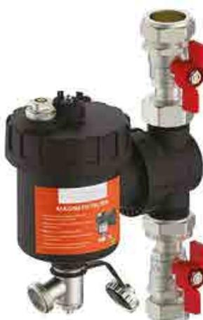
Filtro defangatore magnetico permette la separazione di aria, sporco, impurità magnetiche dal sistema in cui è installato. E' costituito da un potente magnete e da un particolare filtro a perle. Nelle normali condizioni di funzionamento le perle all'interno del filtro grazie al loro galleggiamento creando un film filtrante. Le impurità presenti nel sistema si bloccheranno tra i piccoli spazi formatosi tra le perle. Quando lo scarico viene aperto le impurità verranno scaricate fuori.
