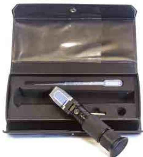
Strumento ottico di precisione, utilizzato per misurare la concentrazione di sostanze in soluzione. Il suo funzionamento è basato sulla rifrazione della luce nei liquidi. Il passaggio della luce attraverso un liquido mostrerà un angolo di rifrazione sulla scala del rifrattometro determinando la quantità di solidi disciolti nel liquido. E' ideale per la misurazione:
