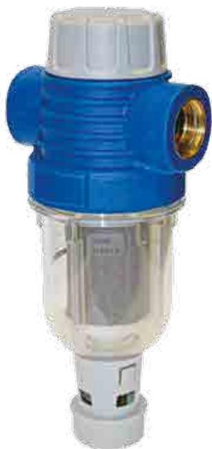
Filtro pulente semi-automatico per la filtrazione dell'acqua potabile. Azionando la manopola di lavaggio si attiva la rotazione del sistema interno di filtrazione che verrà spazzolato internamente nella sua superficie. Ad ogni manovra di pulizia lo sporco accumulato sulla cartuccia e all'interno del bicchiere verrà scaricato. Questo sistema non presenta quindi il problema della sostituzione della cartuccia filtrante o pulizia della stessa, con dei notevoli vantaggi economici e pratici.
