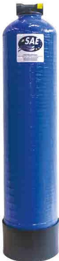
Sistema composto da una bombola contenente resine a scambio ionico cationiche forte per produzione acqua addolcita a 0°f, ed da una testa con attacchi IN/OUT da 3/4" in materiale plastico.
