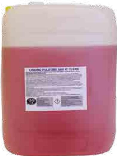
SAE IC CLEAN è un pulitore con protettivo per grandi impianti termici e condominiali che libera i circuiti dal calcare, dalla ruggine e dalle sedimentazioni di fanghiglia, aumentando la resa dell'impianto. Il prodotto viene impiegato per la pulizia in caso di risanamento degli impianti, oppure per ripristinare impianti vecchi. Il prodotto è impieghabile con tutti i materiali in uso come acciaio, alluminio e materiali sintetici.
