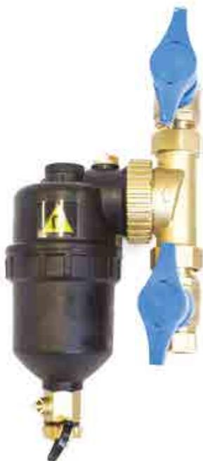
Filtro defangatore magnetico ad alte prestazioni che attraverso un'azione elicoidale separa e rimuove dall'acqua dell'impianto tutte le impurità come ossido di ferro, fanghiglia, depositi di varia natura, sabbia, ecc. ROTAMAG è molto versatile grazie al corpo deviatore snodabile e permette un montaggio inclinato sino a 45°, in presenza di limitazioni sull'altezza disponibile per il montaggio del dispositivo.
