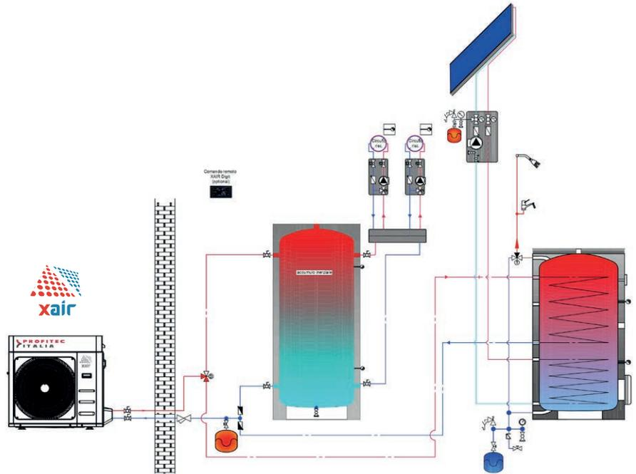
Impianto di riscaldamento e raffrescamento con pompa di calore **Xair** con accumulatore inerziale per l'impianto di climatizzazione e boiler **Monoplus** per la produzione dell'ACS.
