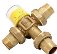
Per impianti solari con attacchi a bocchettone filettati maschio. Pressione massima esercizio 10 bar. Temperatura massima 100°C. Temperatura di regolazione 30-60°C.
