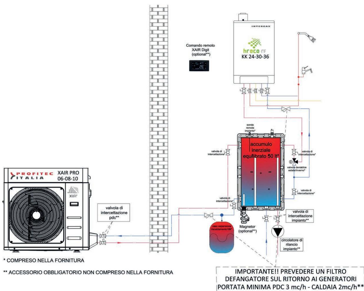
Il sistema XAIR Pro Hybrid è composto da una caldaia modello HR Eco e da una pompa di calore XAIR Pro, collegate su un sistema idraulico con funzione di compensatore e accumulo inerziale da 50 lt.
