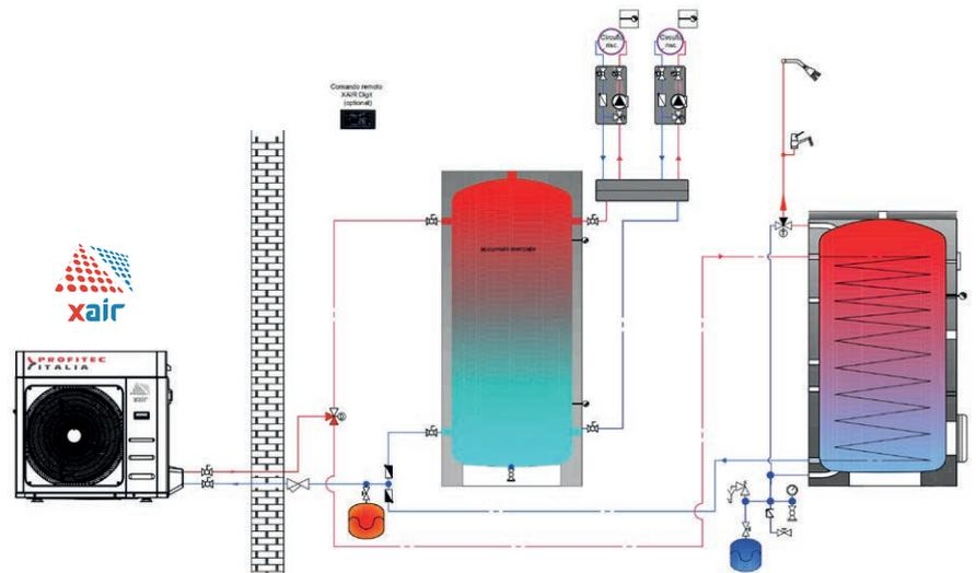
Impianto di riscaldamento e raffrescamento con pompa di calore **Xair** con accumulo termico sul circuito di ritorno per l'impianto di climatizzazione e produzione ACS con scaldabagno istantaneo a condensazione marca **Intergas modello Superflow**
