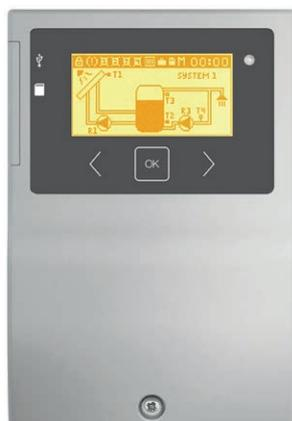
Apparecchiatura elettronica digitale programmabile per il controllo degli impianti solari termici comprensivi di collettori solari, pompa di circolazione ad alta efficienza, serbatoio di accumulo ed eventuale riscaldamento integrativo. Oltre alla funzione basilare di regolatore differenziale di temperatura, è in grado di ottimizzare le prestazioni dell'impianto grazie alla possibilità di pilotare una pompa modulante PWM, offrendo numerose funzioni per la protezione dell'impianto stesso.
