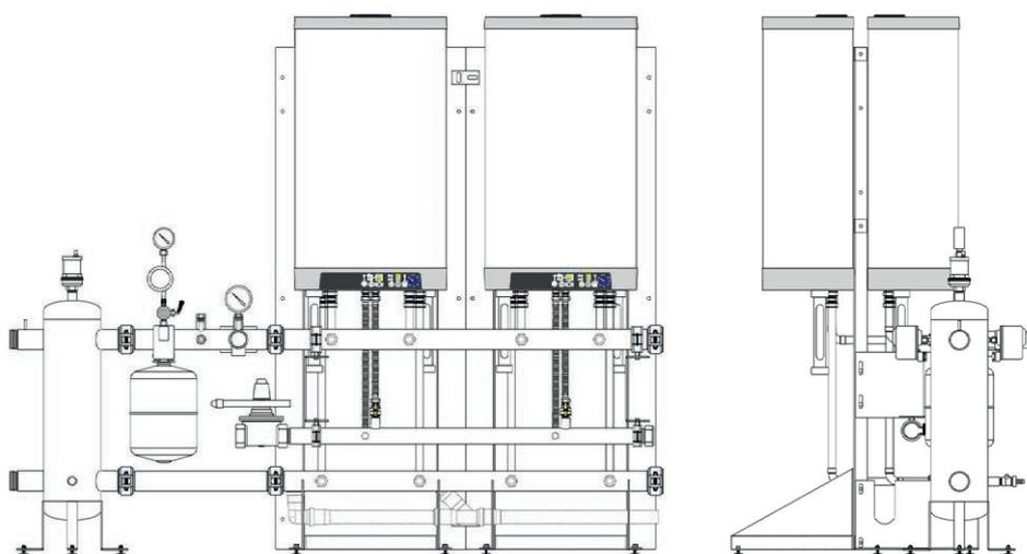
Sistema modulare per esterno completo di modulo di contenimento autoportante (STML e STMS)
